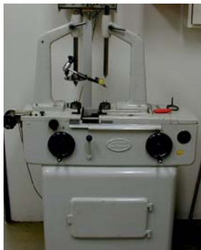
Mahr 895 C. Eines der ältestens Geräte. Ausführungen mit Handrad oder Motorsteuerungen wurden gebaut.
