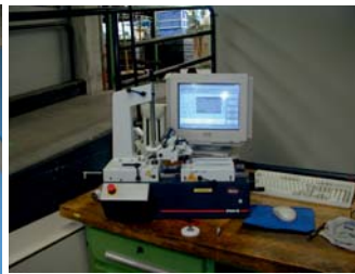
Mahr 898B links komplett zerlegt, überholt, geschliffen und lackiert. Rechts ein etwas neueres Gerät, hier wurde die Elektronik und die Messtechnik auf den neusten Stand gebracht und über die Software DF1 WinGear TCPIP angesteuert.
