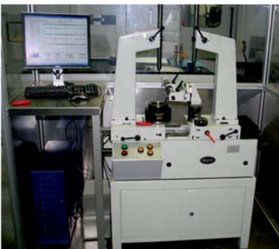
Mahr 895 C. Eines der ältestens Geräte. Ausführungen mit Handrad oder Motorsteuerungen wurden gebaut.
