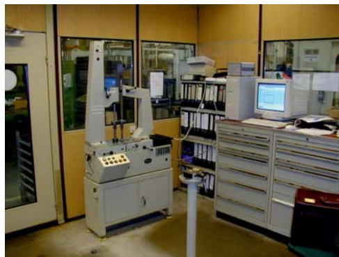
Mahr 898C mit kleinem und großem Widerlager. Die Steuerung der Pinole erfolgt mit dem Bedienpult. Die Messung wird über das Programm DF1 WinGear TCPIP gesteuert.
